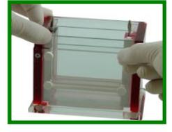
五. 將玻片組架上電泳槽，旋緊槽上四個旋鈕。
