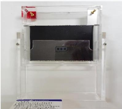
7.將組合完成的轉漬槽內槽水平推入轉漬外槽中。
